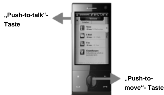
Abbildung 2: Getesteter Prototyp und Lage der relevanten Steuerelemente
